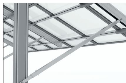
Fixarea diagonalei la pilon cu profilul C
