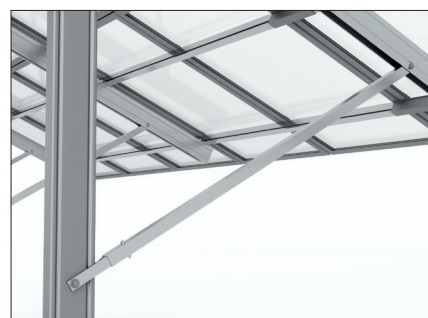
Connexion de la diagonale au poteau C-Post
