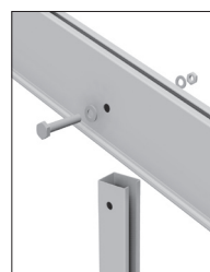
Details van verbinding: steunpoot-spoor
