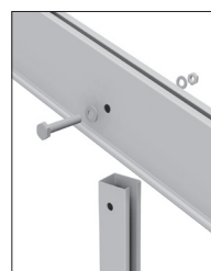
Dettaglio della connessione Supporto - rafter
