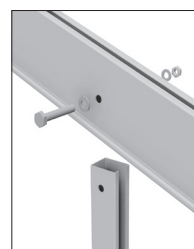
Detalle de la conexión - Balsas
