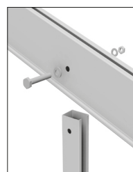
Details van verbinding: steunpoot-spoor
