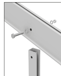
Detalle de la conexión - Balsas
