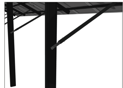
Connexion de la diagonale au poteau C-Post
