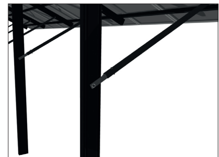
Anbindung der Diagonale an den C-Pfosten
